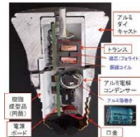
図3. 根元部の断面構造 縦横に切断し、粘土状樹脂を除去している。
