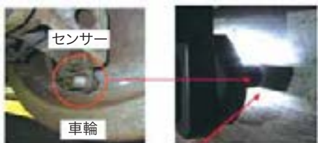
写真1 脱線係数を測る輪軸を電車に取り付ける状況
