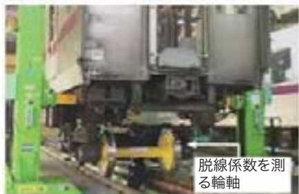
写真1 脱線係数を測る輪軸を電車に取り付ける状況
