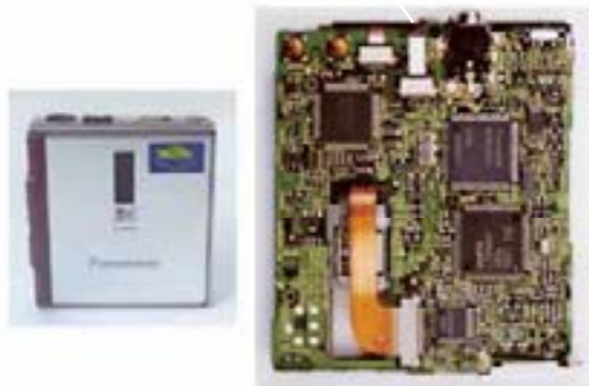
写真1 Sn-Ag-In-Bi系で1998年にリフロー量産を果たしたMDとその実装基板(パナソニック)
