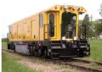
写真2 レール削正車
