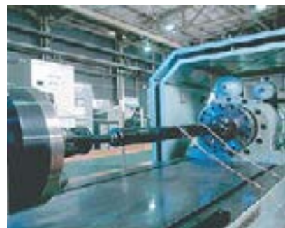
写真2 大型ねじり疲労試験機
