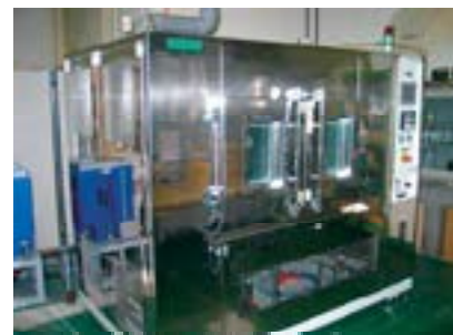
写真3 複合サイクル腐食試験機
