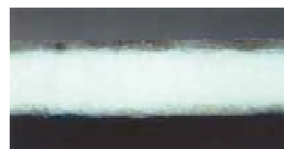
(a)牛乳容器(3層構造) 200μm
