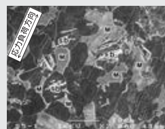
写真2 ● マルテンサイト(M)間のフェライト(黒色部)に発生したすべり帯(sb) (SEM観察)
