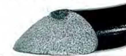
【写真3】応力集中部より破損した軸の破面状況(片側平面曲げ)
