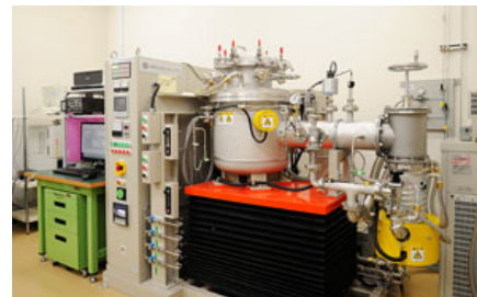
図3 自由共振法ヤング率、剛性率測定装置外観
