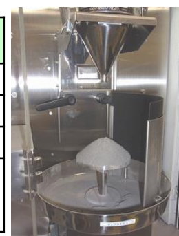
マルチテスタ(MT-1) による安息角測定
