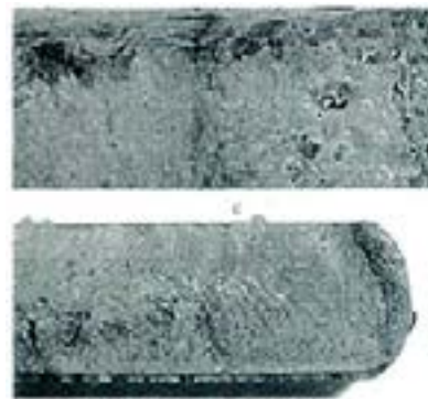
【写真8】 板ばねの腐食疲労損傷状況
