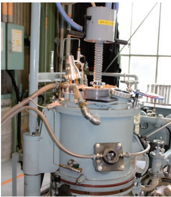
図1 ボタン溶解炉の外観
