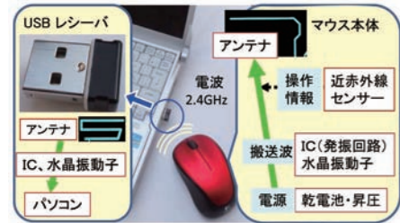
図1. 無線マウスの送信と受信の仕組み マウスの情報は本体のアンテナから2.4GHzの電波が発信され、レシーバのアンテナで受信する。
