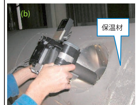
図4. 実機ひずみ計測
