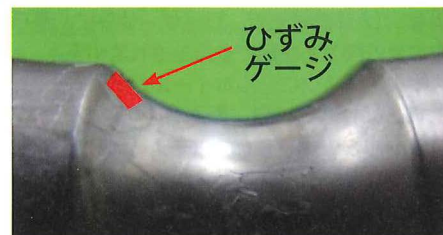
図1 ひずみゲージ貼付状況
