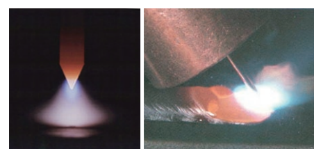
ティグ溶接 (SUS304) マグ溶接 (SS400) 図1 ティグ溶接におけるアークの状況とマグ溶接
