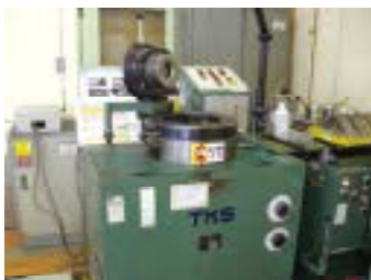
写真1 深絞り試験機
