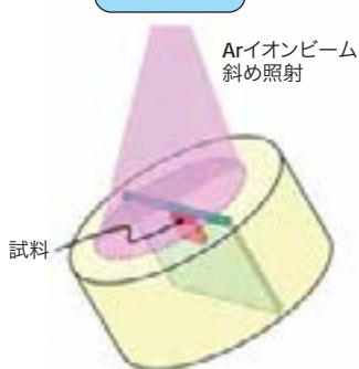
図2 平面ミリングの原理※
