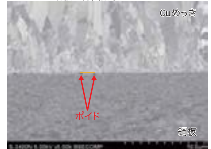
写真2 イオンミリング後の断面SEM観察結果
