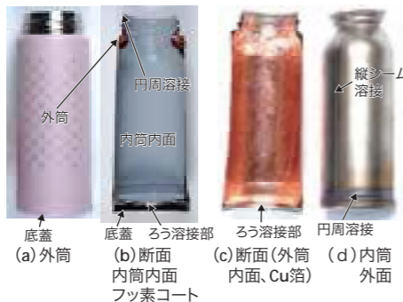
写真1 ステンレスマグの断面写真
