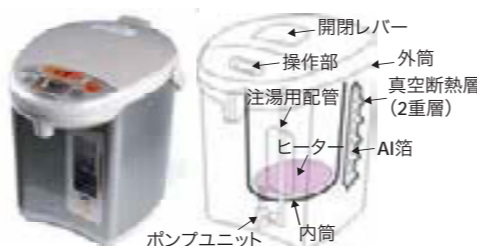
写真3 電気ポット外観と構造
