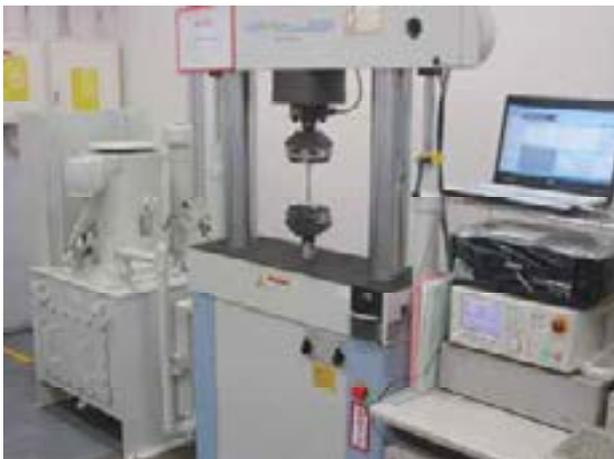
写真1 100Hz対応電気油圧サーボ疲労試験機
