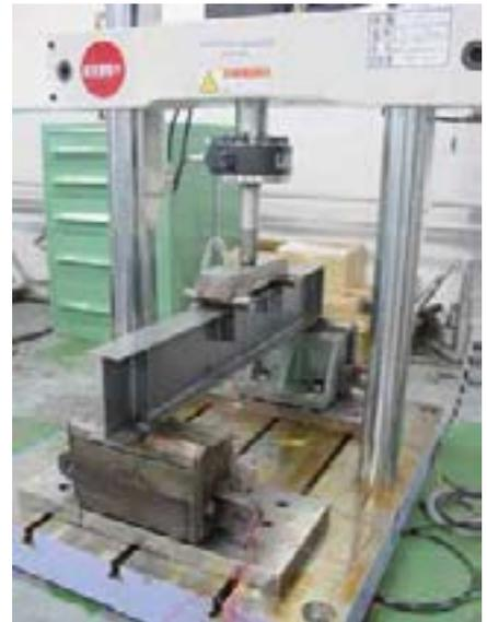
写真2 定盤式電気油圧サーボ疲労試験機
