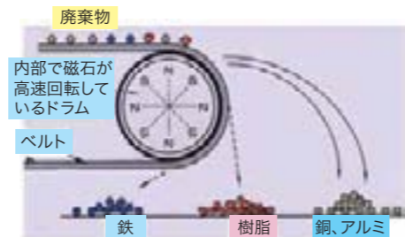
図5 磁気選別機 銅やアルミに急激な磁束変化を与えると、金属内に渦電流が発生し、反発して飛び出る。(日立金属(株)資料)
