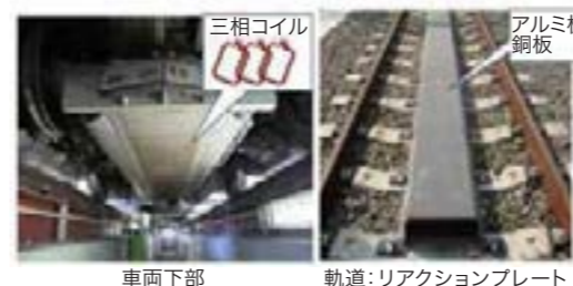
図8 鉄輪式リニアカー 車両下部からの磁束でリアクションプレートに反発電流が流れる。これをずらしながら繰り返して推進する。(左は福岡市交通局資料)
