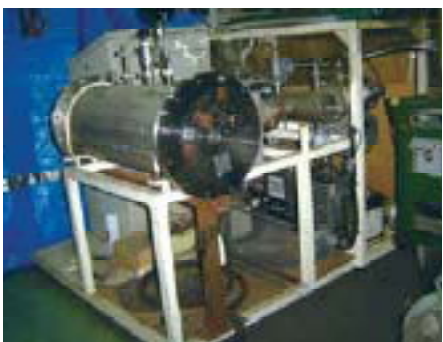
写真2 真空ポンプと減圧試験容器
