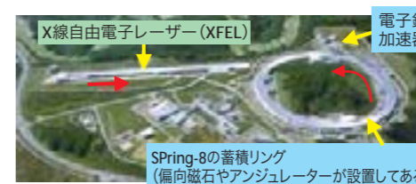
図8 2) 播磨学園都市にある放射光発生施設 (SPring-8とXFEL) (赤矢印は電子の進む方向)
