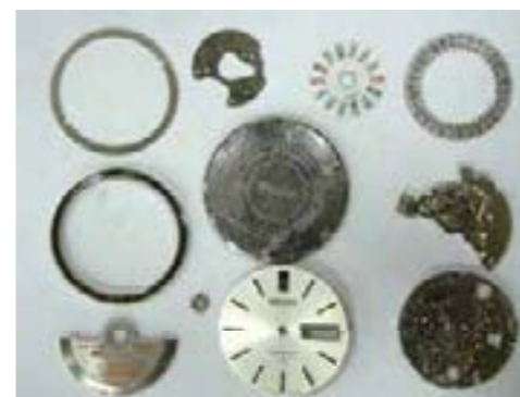
図7 解体した時計のケースなど
