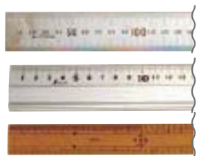
写真2 直尺(ステンレス製、アルミニウム製、竹製)
