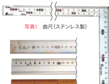
写真2 直尺(ステンレス製、アルミニウム製、竹製)
