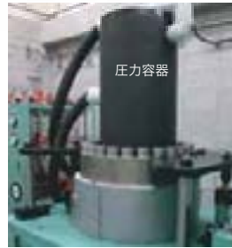
装置仕様 圧力：大気圧～70MPa 温度：室温～80℃ 定格負荷：±30kN 試験速度：0.001Hz～10Hz
