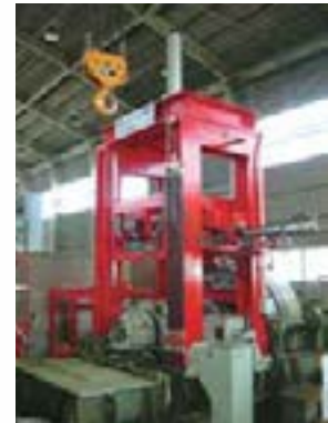
写真2 車輪・レール接触往復運動ユニット (車輪の低速乗り上がり現象を評価)
