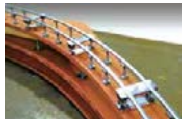
写真3 走行実験装置(東京大学が運輸施設整備事業団の助成を受け製作) (台車の曲線部軌道走行性能評価)
