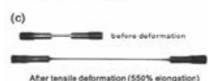
図5 (a)二相ステンレス合金のbcc( \alpha )+fcc( \gamma )微細二相組織のTEM写真、(b) \alpha 母相のKikuchi回折測定で求めた高温変形時の粒界方位差の変化 3) 、(c)二相ステンレス鋼の超塑性変形。
