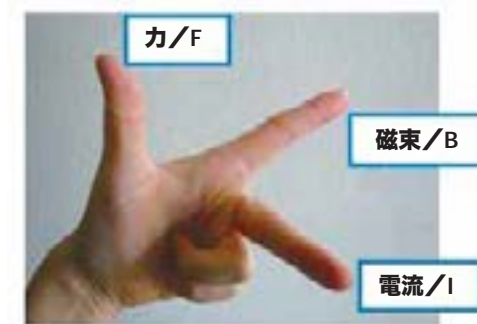
図5 フレミングの左手の法則(力/Fの方向を求める。親指からFBIと憶える)
