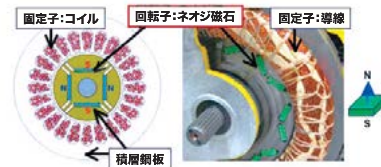
図8 Nd磁石を使用したモーター回転子の例(積層鋼板製回転子の中に板磁石が埋められている。左:圧縮機、右:HEV)
