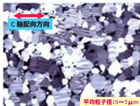
図2 ネオジム磁石のKerr効果顕微鏡組織(横方向に磁場をかけ粉末成形後に、焼結、Nd 2 Fe 14 B結晶のC軸が横方向に揃っている。コントラストは磁区模様、着磁前)
