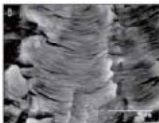
ストライエーション(疲労破壊) 流れ模様(応力腐食割れ) 写真3 ミクロフラクトグラフィ(SEM観察)
