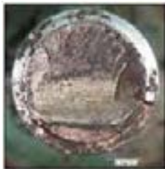
写真1 マクロフラクトグラフィ(目視観察)
