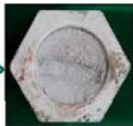
写真1 マクロフラクトグラフィ(目視観察)
