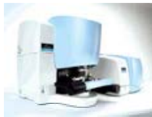
写真1 FT-IR分析装置の外観
