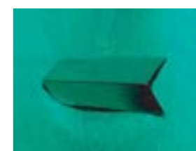
図7 極薄箔(100μm厚)の溶接例
