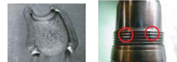
図8 レーザによる補修溶接
