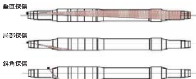
図1 車軸の超音波探傷方法
