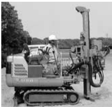
写真1 自走式ボーリングマシンの例
