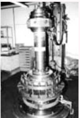
写真3 ホイール曲げモーメント耐久試験機
