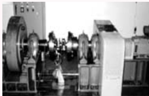
写真2 クランク軸振り疲労試験機
