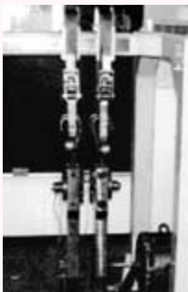
写真1 クランク軸曲げ疲労試験機
