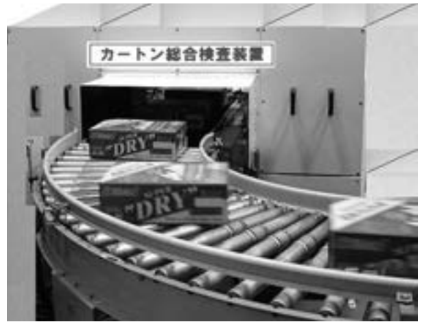
写真1 短辺カートン検査装置概観
