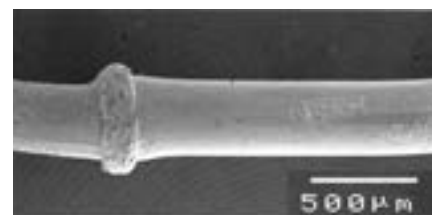
写真4 ●ジュメット線とリード線との突き合わせ接合部
