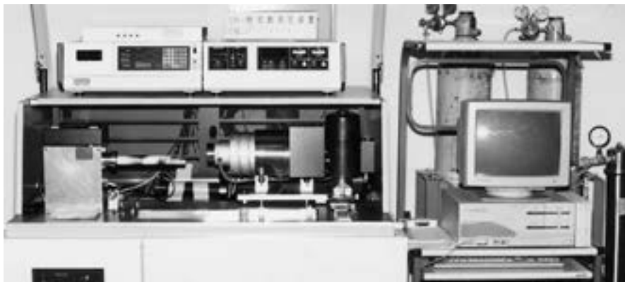
写真●レーザーフラッシュ法熱伝導率測定装置
