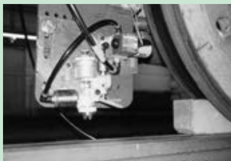
写真1 ● 車上液体塗布方法の一例
