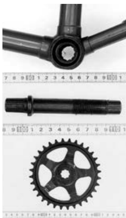
【写真3】ペダルの回転軸とスプロケット(最上段はフレーム下部の回転軸取付部)
