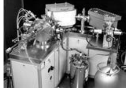
【写真2】グロー放電質量分析装置(GDMS)
