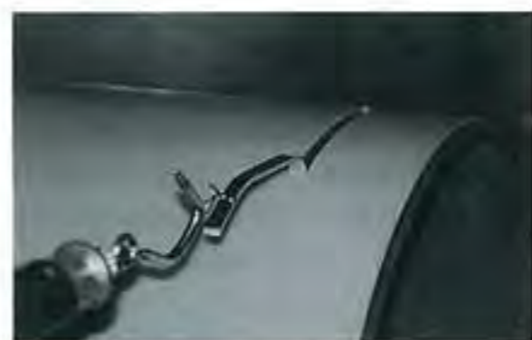
【写真4】剝離試験状況
