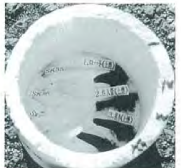
写真3 ゼーゲルコーンによる耐熱性の評価 標準コーンと試料コーンの溶融状況 (白色：標準コーン、茶色：試料コーン)
