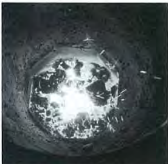
写真1 高周波溶解炉によるスラグ浸食試験 炉上部より炉内を見る（溶鋼=1600℃） 試験片と溶融スラグ（暗赤色部）が見えます。
