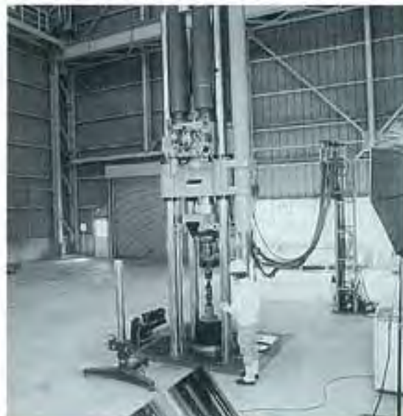
写真1 破壊靱性試験の状況
