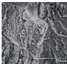
a. 疲労破壊破面
