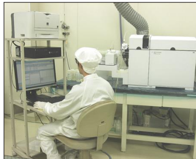
*3) ICP-MS分析装置 アジレント・テクノロジー(株)製 Agilent7700x
