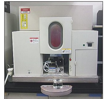
*4)フレームAA分析装置 (株)日立ハイテクノロジーズ製 Z-2310
