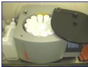
*1)マイクロ波試料分解装置 (株)アナリティックイナ ジャパン製 Speedwave MWS-3+ 試料に応じた最適分解プログラムを適用
