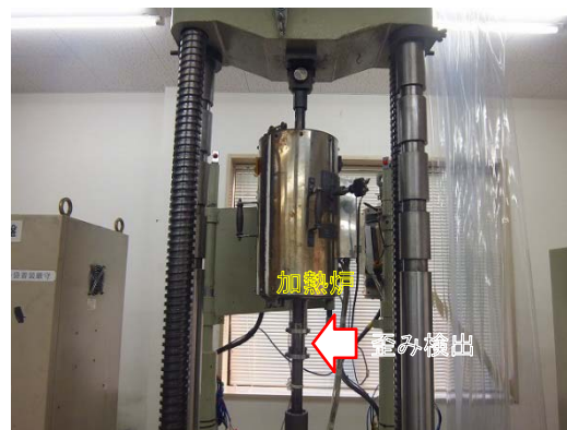
写真2 高温引張試験機 加熱炉拡大
