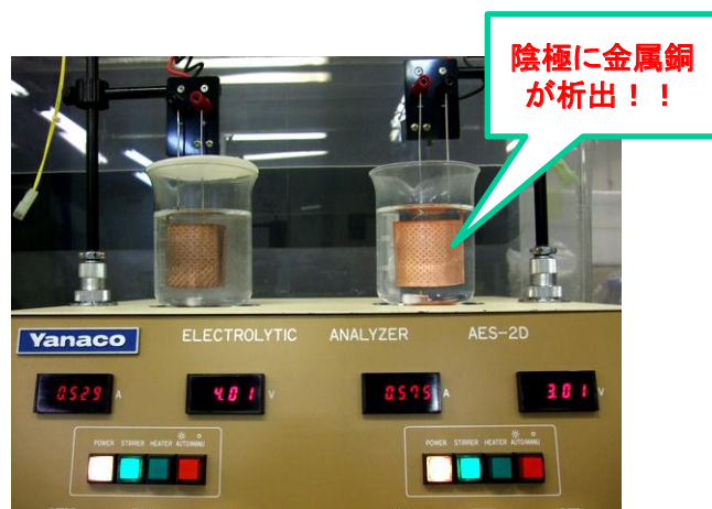
(株)ヤナコ機器開発研究所製 電解分析装置 型式AES-2D
