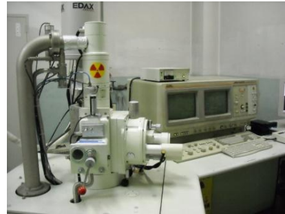
日本電子製 JSM-6400 走査型電子顕微鏡
