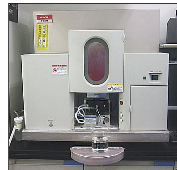
フレイムAA分析装置外観 株式会社日立ハイテクノロジーズ製 Z-2310
